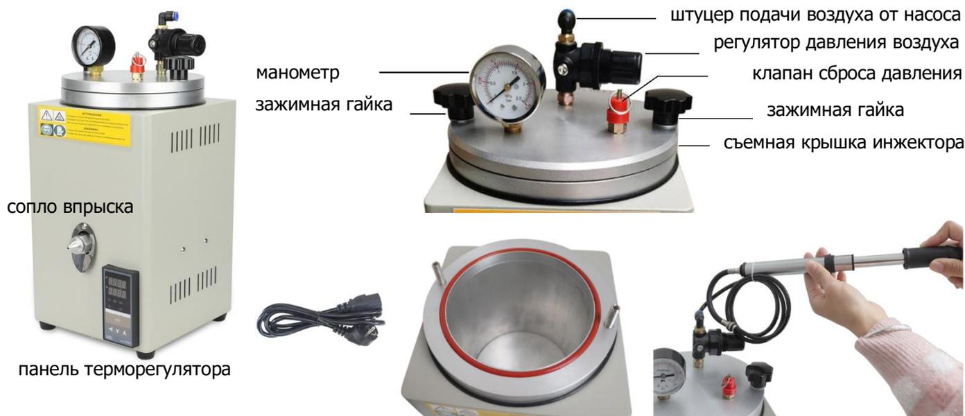
Инжектор оснащен прочным и надежным резервуаром из легкого алюминиевого сплава. Нагрев по всей окружности осуществляется с помощью ленточного элемента, обеспечивая равномерную температуру внутреннего объема, и позволяя получить однородные восковые модели. Выпускной клапан обеспечивает непрерывную струю воска через сопло впрыска, без воздушных пузырьков.
