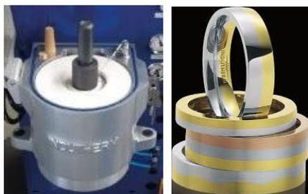
Комплект для синтерирования позволяет спекать до 6 колец (кольца соединяются диффузией за счет тепла и давления, требуемое давление создается пневматически). Комплект может быть установлен в любую машину серии VC. Перевод машины к выполнению данной операции выполняется за несколько минут, последующий производственный цикл не превышает 6-7 минут, включая установку и снятие деталей.
