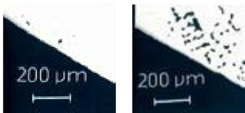
Пористость металла при литье с вибрацией и без вибрации
