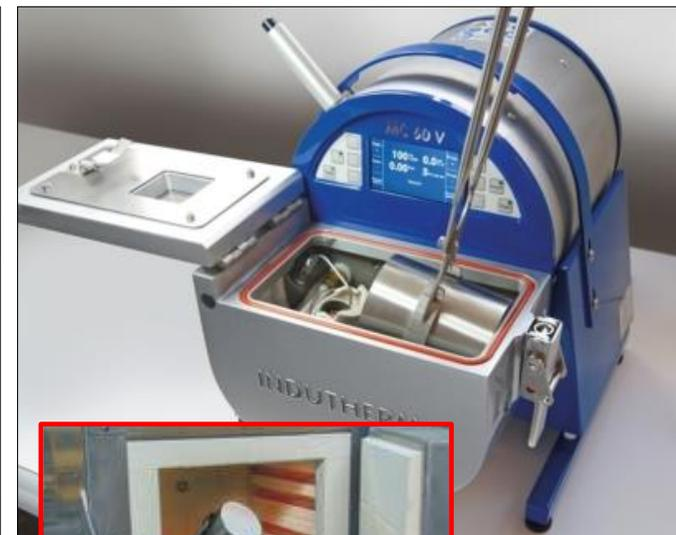
Установка тигля и терпары в плавильно-заливочную камеру. Засыпка металла в тигель. Установка адаптера (переходника) опоки. Подготовка опоки в муфельной печи (вытопка-прокалка) и её установка в камеру. Ввод параметров процесса на ЖК панели.
