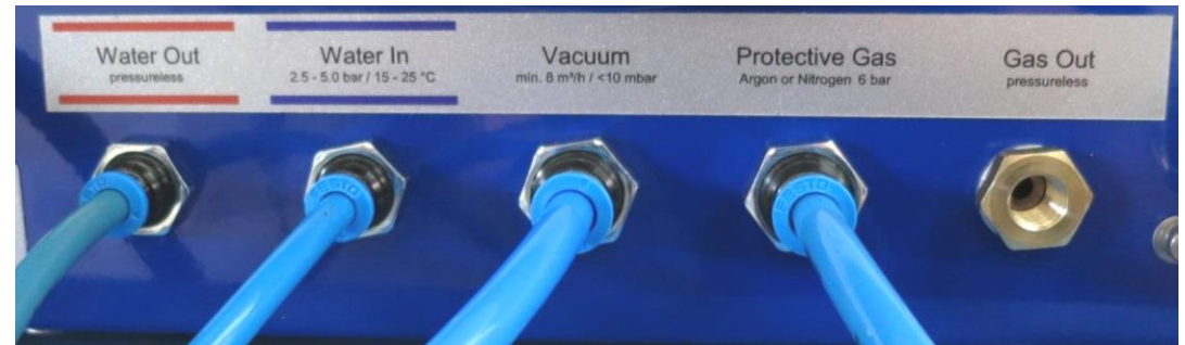
Подключение водяных и газовых магистралей
