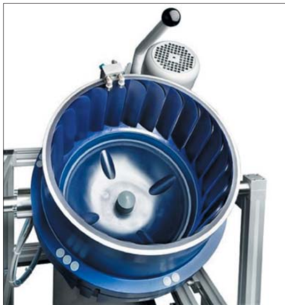
CF 1x18 Element (модель с одним рабочим контейнером объемом 18 л). Возможно расширение от 1 до 4 рабочих контейнеров.
