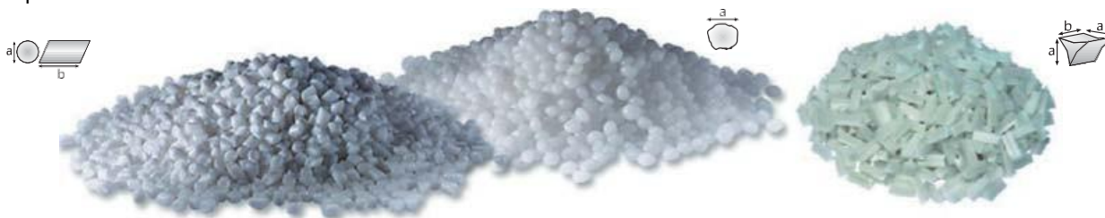
ZS FP - цилиндр (срез под 45°), L FP - гранулы с неровными краями, D FP - трехгранная призма (“стиллет”)
