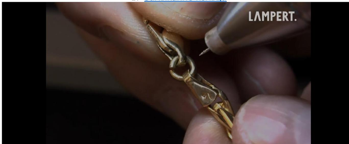
18 [Заваривание трещины в полем кольце](#)
