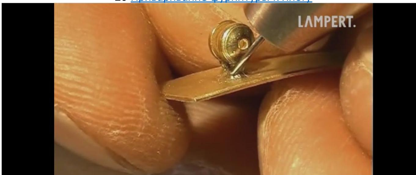
27 [Замыкание пружинного замка](#)
